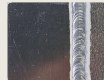
De MIX TIG-functie combineert de goede kwaliteiten van gelijkstroom en wisselstroom. Dit maakt het lassen van aluminium materialen eenvoudig en reduceert de krimpvervorming.
